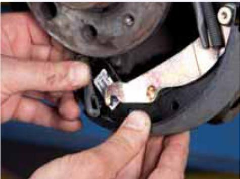
2. Schieben Sie wie im Bild gezeigt, das TopKit zwischen Nabe und Ankerplatte ein.
