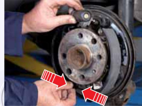
4. Drücken Sie die Bremsbacken unten in Pfeilrichtung zusammen. Danach montieren Sie den Radzylinder ganz einfach.
